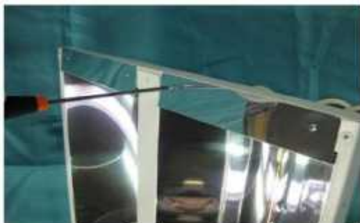
2. DEVISSER LES (4) VIS QUI BLOQUENT LA PARTIE SUPERIEURE DU REFLECTEUR ET LES ENLEVER
