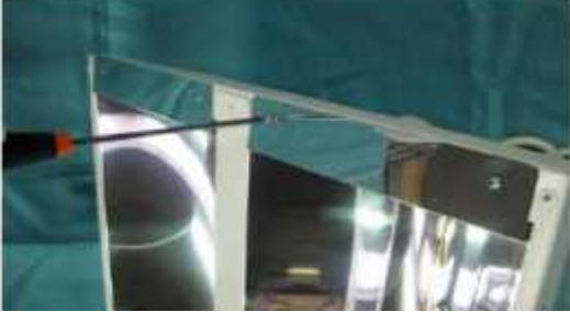
2. DIE VIER SCHRAUBEN (4) ZUR BEFESTIGUNG DER SEITLICHEN KOPFSTÜCKE DES REFLEKTORS LÖSEN UND SIE
