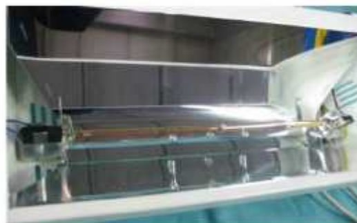
7. REINSERER LES JOINTS SILICONIQUES DANS LES DEUX RESSORTS COMME EN ORIGINE
