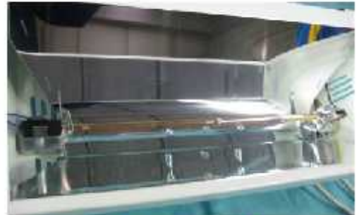
7. VOLVER A COLOCAR LAS GUARNICIONES DE SILICONA EN LA SEDE DE LOS DOS RESORTES, COMO SE ENCONTRABA.
